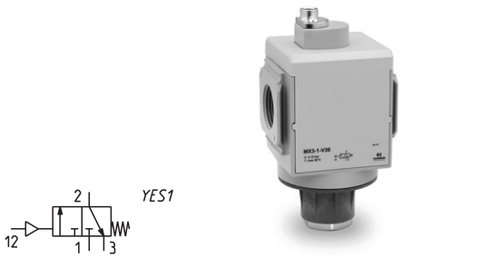
YES1 = пневматический клапан безопасности, 3/2 лин./поз., Н.З., моностабильный
