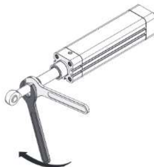
Рисунок 19 – Установка принадлежностей на шток.
